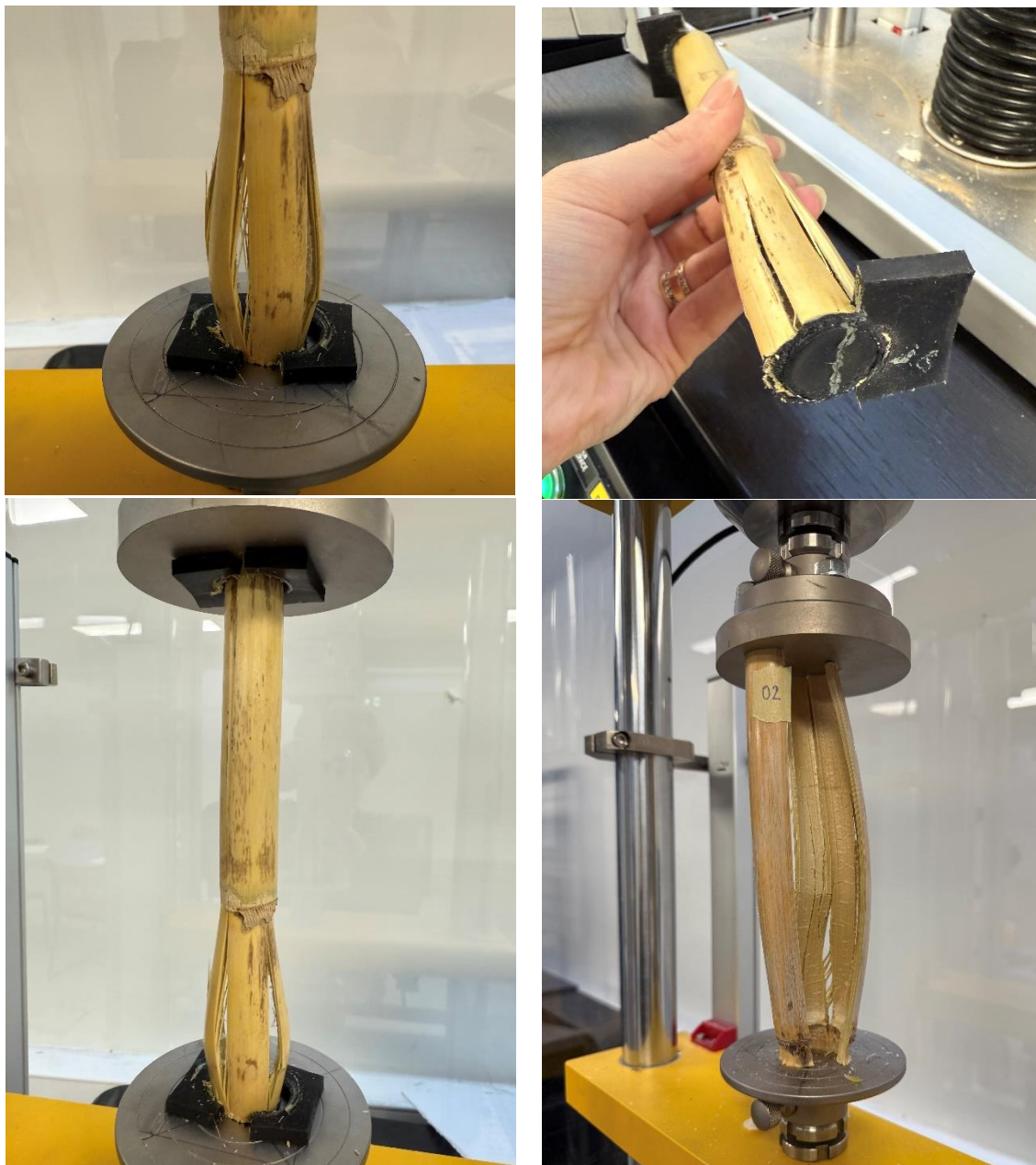
FIGURE 2 LES ECHANTILLONS DE CANNES APRES LA RUPTURE, AVEC ET SANS LA MEMBRANE EN CAOUTCHOUC
